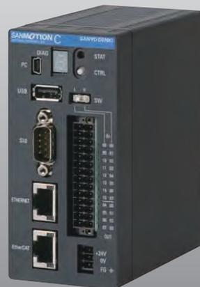
SANMOTION C は、入出力信号の制御と同時に、複雑な多軸モーション制御や、ロボット制御をおこなえます。お客さまの用途に合わせて、柔軟にシステムを構築できます。
