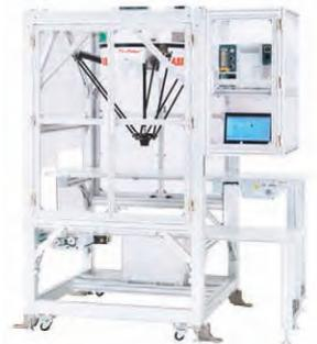
パラレルリンクロボット架台
