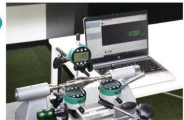
偏心検査器に取付、振れ測定
