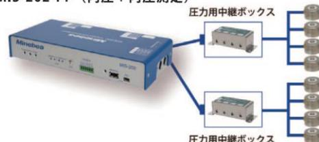
● 圧力、圧力 各4CHの組み合わせです
