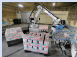
標準タイプ Ai700 処理能力:700サイクル/h 可搬質量:140kg 160kg(オプションカウンターウェイト追加)
