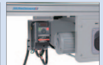
200W変速仕様には「IE3」を クリアしたIPMモータを採用。
