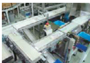
そうめん工場 金検後に設置されたベルコンミニ。流れ方向を変えるため、直交合流方式になっています
