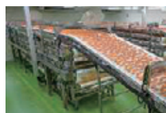
ドーナツ工場 JPLを多段式にした揚げたてドーナツの冷却ライン
