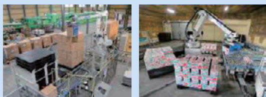
標準タイプ Ai700 処理能力:700サイクル/h 可搬質量:140kg 160kg(オプション:カウンターウェイト追加)
